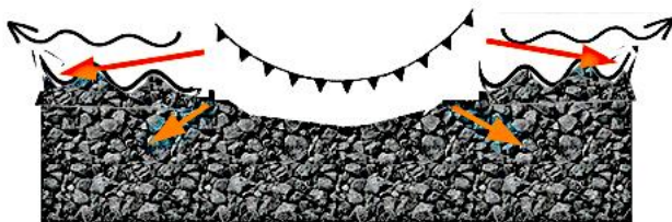
Abb. 2. Modell zur Entstehung von Wellenstrukturen bei KH-Instabilität. Beim Einschlag wird die niedriger viskose Schicht leichter und mit höherer Geschwindigkeit nach außen gedrückt als die höher viskose, zähere Schicht.
